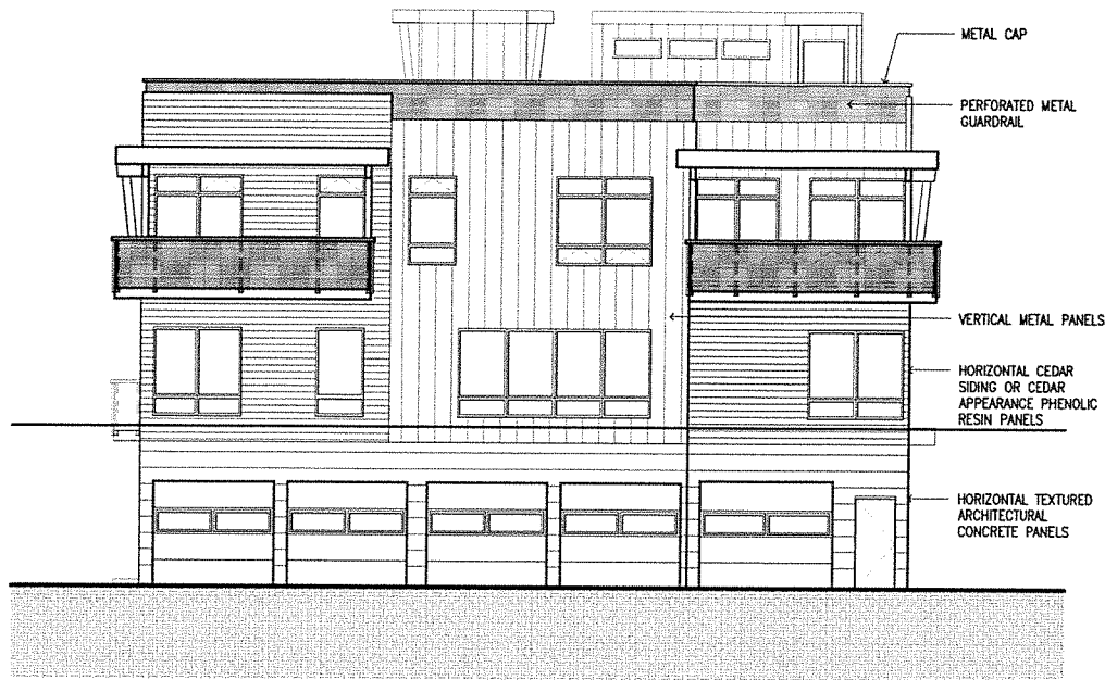
1 EAST ELEVATION SCALE: 1/8" = 1'-0"
